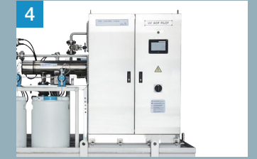
4 控制系统 低压/中压设备运行及功率调节 选择操作模式 可监测当前运行条件 (流量、温度、紫外线强度值等)
