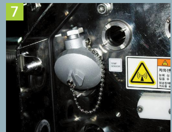
7 温度传感器 防止系统损坏及保障用户的安全
