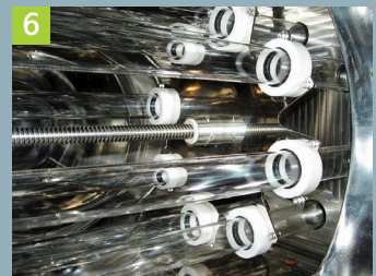
6 马达驱动型自动清洗装置 定速运转的马达驱动方式的高效清洗装置
