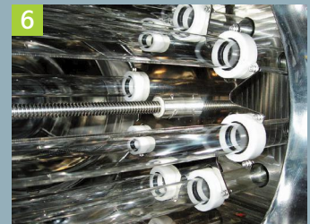
모터구동형 자동세척장치 경속운전이 가능한 모터구동방식의 고효율 세척장치
